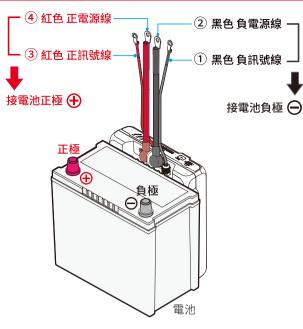
若電源線與訊號線連接正確,Battery指示燈號將點亮並顯示綠色 Battery 指示燈號 (亮綠色)
