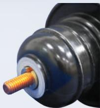
套管井中心導體與外圍環氧樹脂接合面，常因不當的外力操作或年久老化，造成接面細縫，而發生絕緣油洩漏現象，為避免此一不良情況發生，在模鑄前TR-03之中心導體除先添加結合劑，使導體與環氧樹脂充分結合，並於中心導體後端，特別加裝一止油O型環，該O型環採用符合CNS 3550 CII等級，耐油、耐溫性絕佳，可充分阻絕中心導體與環氧樹脂間之洩油通道，提高套管井之可靠度。
